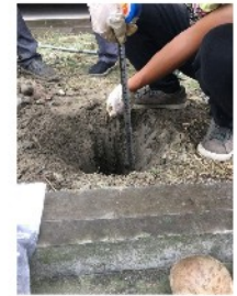
现场采样深度测量
